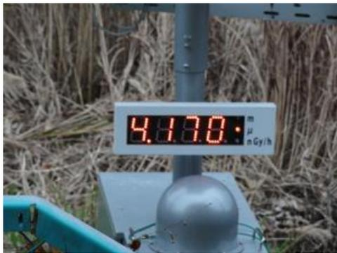
出来るだけモニタリングポストに近い場所（左手前、柵の道路側）に様々な計測器を置き測定すると、おおむね  $4.7 \sim 5.8 \mu\text{Sv/h}$  あたりを示した。地元の方のお話しでは、道路のアスファルトは高压洗浄機で洗った後が見られるという。
