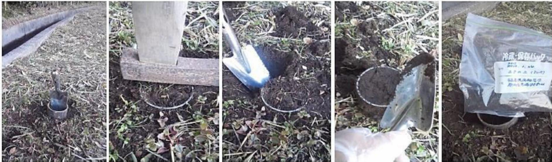
呼び径80A 外径:89.1 厚み:2.8 高さ:50mmの鋼管を使用
